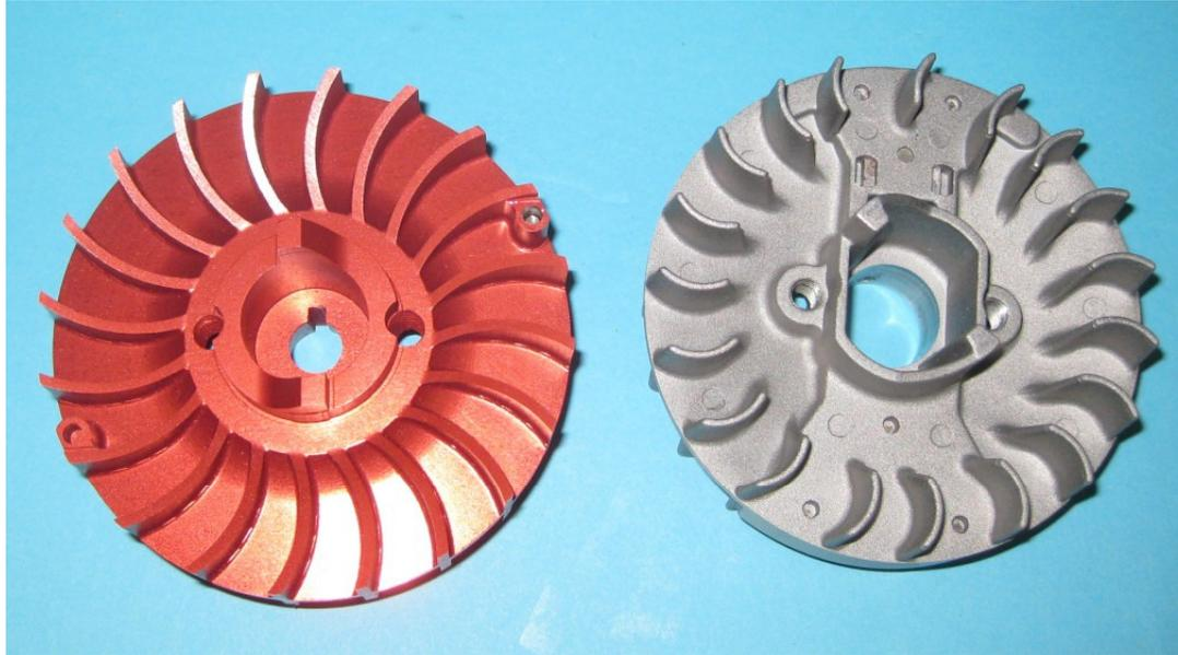
Links das PowerSpark / MATHO Lüfterrad, rechts das Lüfterrad der ersten RCMK CR600FP Motoren, welches im Lieferzustand eine Innenhülse eingepresst hat (nächstes Blatt). Man erkennt, dass das Gussrad bearbeitet wurde: die Innenkontur wurde mittels Drehmaschine auf Durchmesser ca. 19mm gebracht. Wenn man genau schaut, dann erkennt man auch, dass das Gussrad eher von minderer Qualität ist, es sind grosse Lunker (Luftblasen) zu erkennen.
