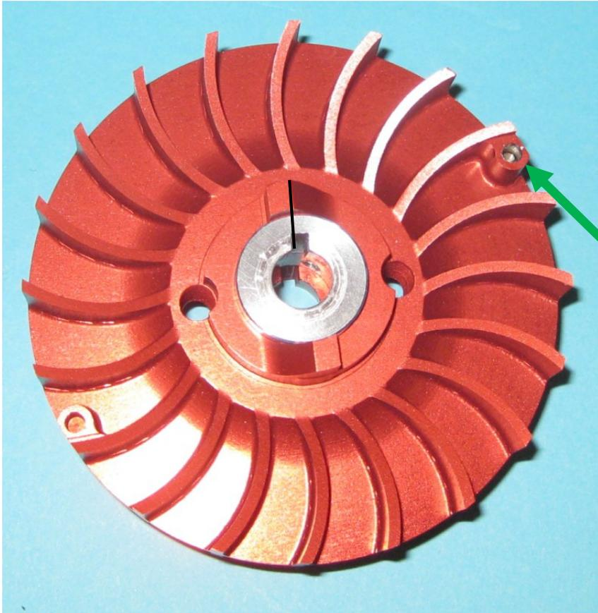
Es ist zu erkennen, wie die Hülse eingesetzt wird: Etwas Öl auf die Innenhülse geben, dann reinschieben und dann auf Position verdrehen, bis Linke Kante der Nut mit der rechten Kante der Starter-Klinke fluchtet. Siehe schwarze Linie.
