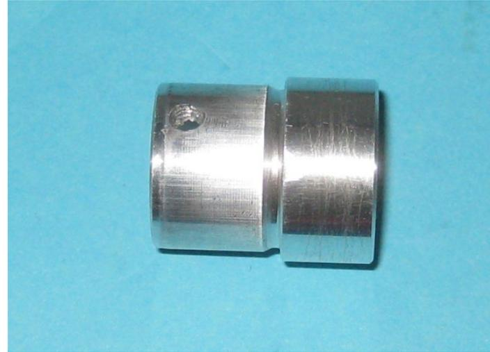
Links die ausgepresste Hülse von der Stirnseite, die dicker ist und im eingepressten Zustand zum Starter zeigt, rechts sieht man das gleiche Teil von der Seite und auch die M3-Bohrung mit der die Innenhülse im Gussrad gesichert ist.
