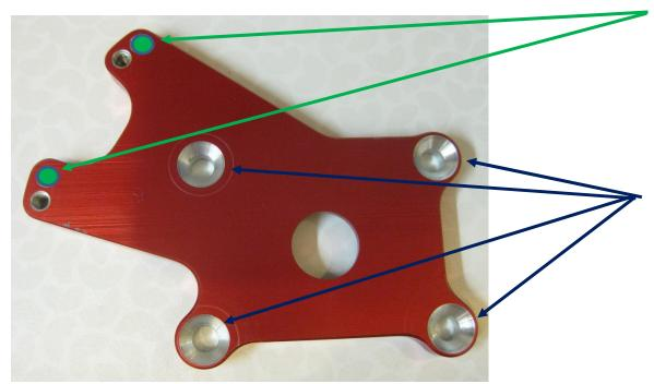
Später müssen dann die beiden oberen Gewindebohrungen für die Befestigung des Sensorhalters verwendet werden
